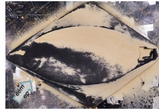
Физическое моделирование коэффициента \mu (НИУ МГСУ) (без учёта окружающей застройки)
